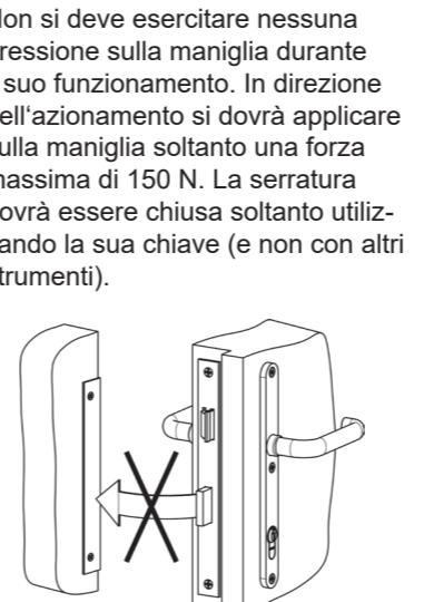
Non si deve esercitare nessuna pressione sulla maniglia durante il suo funzionamento. In direzione dell'azionamento si dovrà applicare sulla maniglia soltanto una forza massima di 150 N. La serratura dovrà essere chiusa soltanto utilizzando la sua chiave (e non con altri strumenti).
