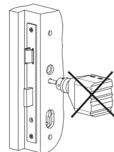
Das Türblatt darf im Schlossbereich nicht bei eingebautem Schloss durchgebohrt werden.
