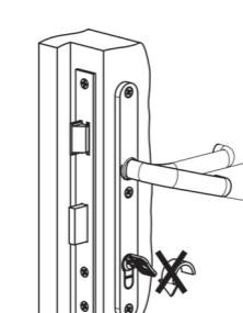
La poignée à bâquille et la clef ne doivent pas être actionnées simultanément. La maniglia e la chiave non possono essere azionate contemporaneamente.
