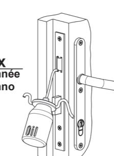
Les serrures doivent être graissées au moins 1 fois par an (ne pas utiliser d'huile à base de résine). Lubrificare le serrature almeno una volta all'anno (non usare olio resinoso).
